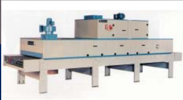
TÚNEL DE SECADO CON ARRASTRE AUTOMÁTICO
